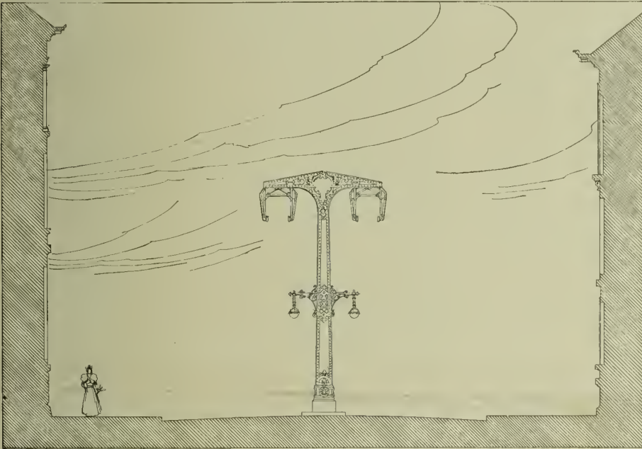
Abbildg. 4. Stütze für breite Strassen und Plätze.
